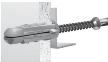
**3.** Visser jusqu'au contact de la vis avec l'objet (à l'aide d'un tournevis ou d'une visseuse)
